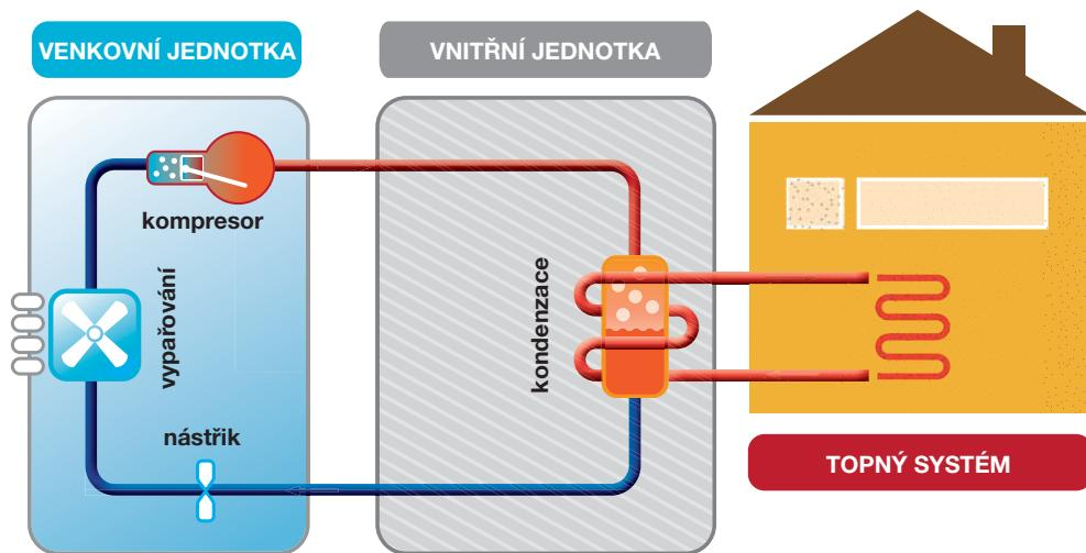
Principem každého tepelného čerpadla vzduch-voda je transport tepla z venkovního prostředí (ze vzduchu) do objektu a jeho využití k topení a přípravě TUV. Energie slunce a sluneční paprsky se starají o stálou dodávku energie, tj. o ohřev planety a venkovního prostředí. Původně nízkoteplotní sluneční energie je tepelným čerpadlem přečerpána na vyšší teplotní úroveň, aby mohla být použita pro vytápění domácností nebo kanceláří.
